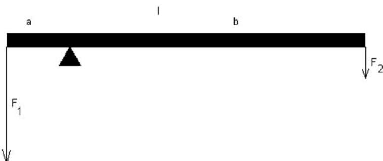
a, b ... ramena sil (vzdálenosti působiště síly od osy otáčení)
